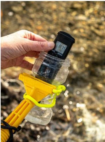
On utilise un conductimètre électrique pour mesurer la concentration de sel dans l'eau.
